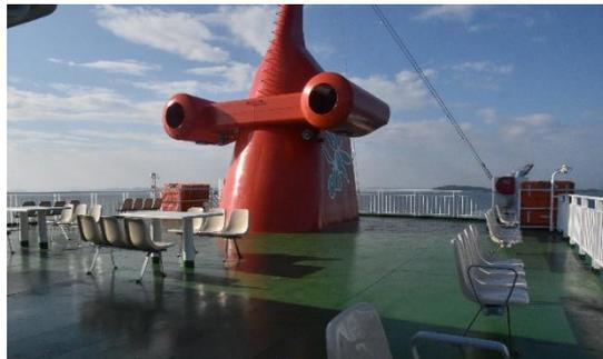
第一しょうどしま丸のオープンデッキです。中央の煙突のように見えるものは、マスト兼客室入口で、右後方に見える小さな排気管が本当の煙突です。
